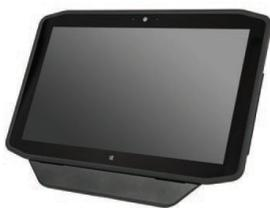
Diese ab Werk installierte Option fügt am Boden des Tablets ein 2D-Barcode-Lesegerät und einen HF-RFID-Lesegerät sowie einen seriellen Anschluss hinzu. Das R12 passt auch mit montiertem SlateMate in Dockingstationen und Taschen.
